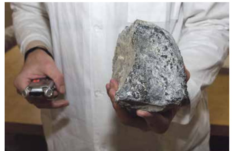
– Результат переработки натрия. В этом камне примерно 1 кг щёлочного металла.
